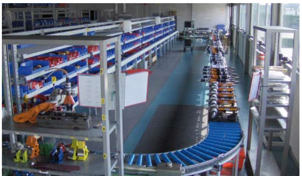
Deel van de montagelijijn. De onderdelen worden niet langer naar het product toe gebracht, maar het product naar de onderdelen.
